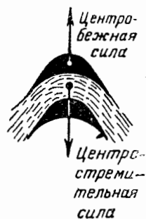
Фиг. 105. Центробежная и центростремительная силы при движении пара между лопатками.
